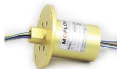
MG系列定子法兰滑环是定子子部分带连接法兰的一系列滑环的总称，实心滑环，中心无通孔，适用于定子法兰安装。由于中间无通孔，在同样的外径大小的前提下，可以实现更多的路数和更大的电流。此类产品由于内部空间充足，在内部走线和特殊屏蔽模块设计方便，更稳定可靠。通常此类产品用于定制各类敏感信号或者编码器信号
